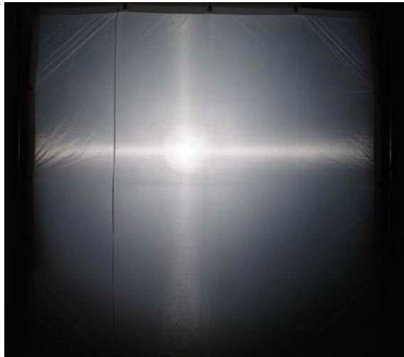
Illustration 8: Toile 2x2 m 1/4 de Grid Cloth diffusant un HMI Alpha 4V2
